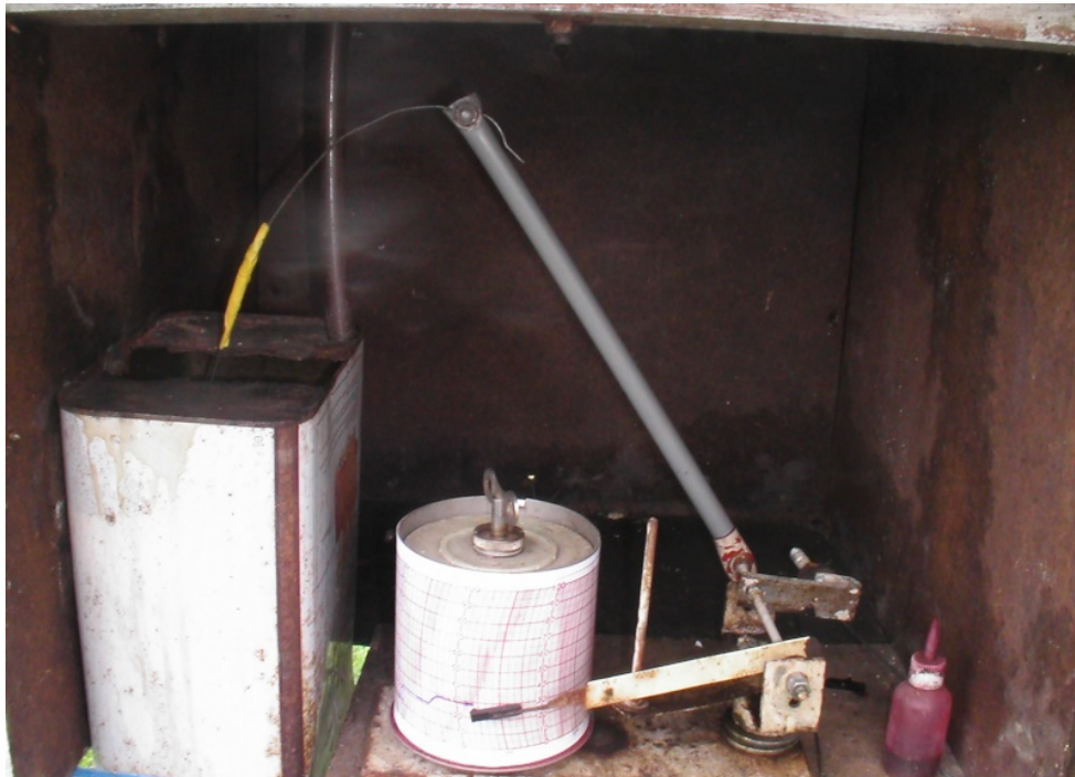
Pluviomètre « maison » fabriqué (et commercialisé ?) par B. Subrin (le Breuil). Photo B. Subrin.
